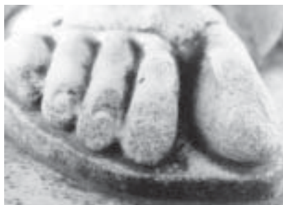
Рис.2 (а, б). Выкрашивание поверхности мрамора, протекающее при участии микроорганизмов
